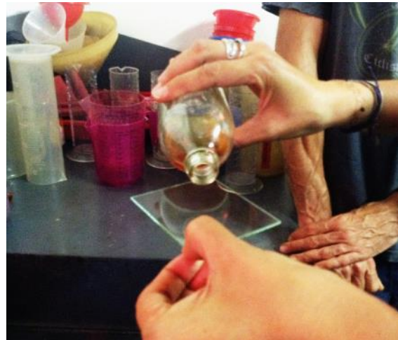
Gießen der Platte mit Kollodiumlösung
