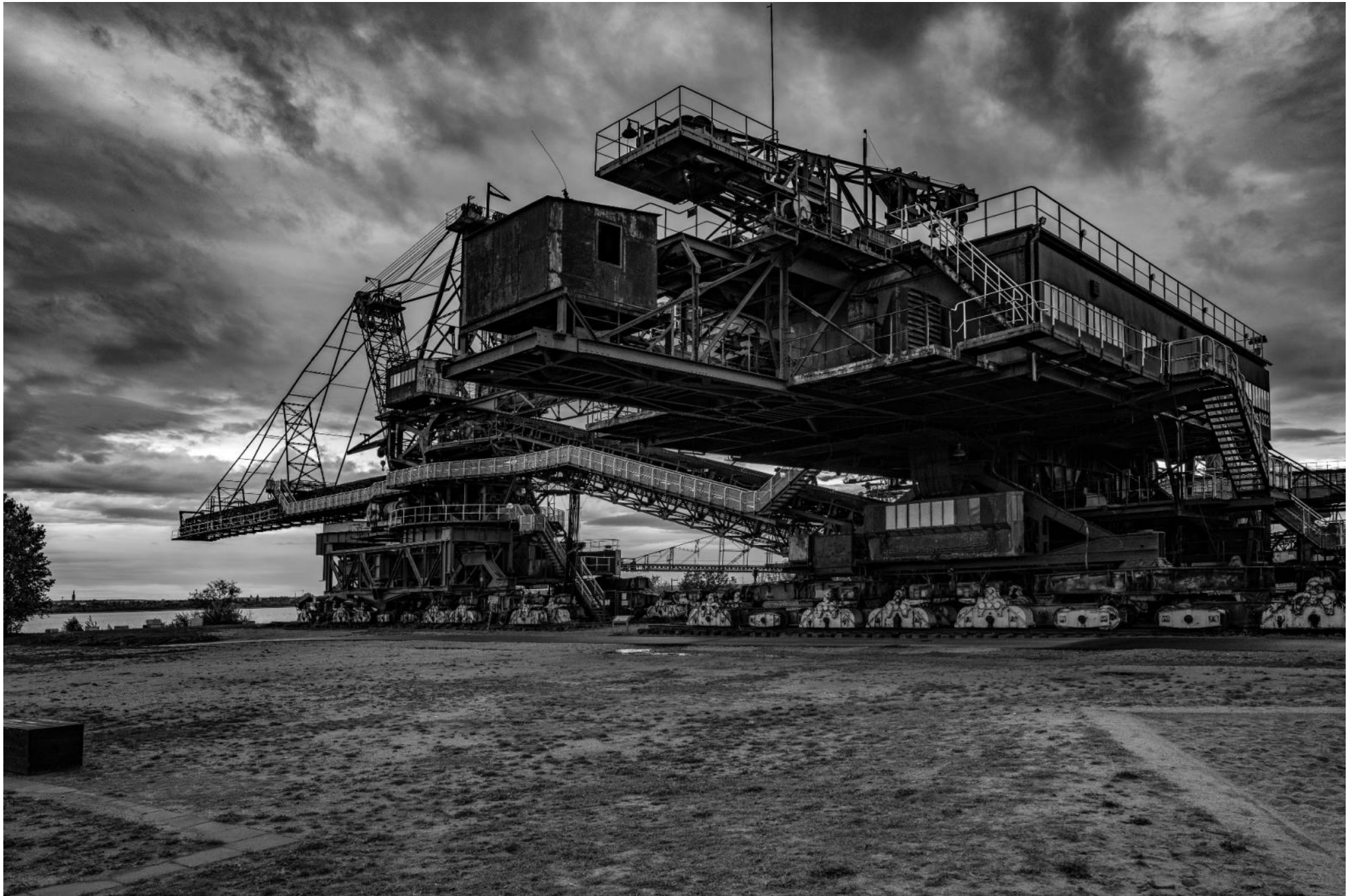
Gemini (Zweiteiliger Absetzer auf Schienenfahrwerk)
